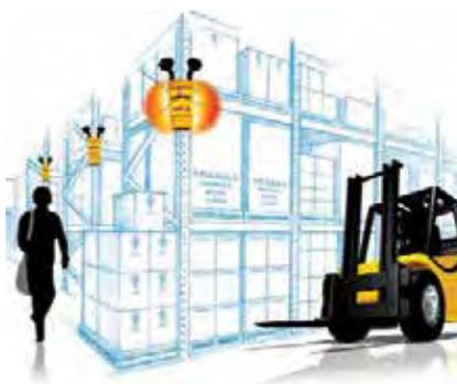
Los puntos ciegos, esquinas e intersecciones pueden causar accidentes debido a una visibilidad deficiente y falta de atención al entorno. Al activar luces brillantes y parpadeantes, los sensores de seguridad ayudan a advertir a las personas antes de que ocurra un accidente.
